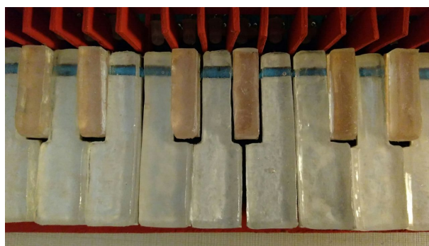
Figura 5: Teclas prontas montadas na estrutura externa
