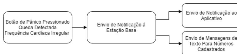
Figura 3: Esquemático para a averiguação de pedidos de socorro.
